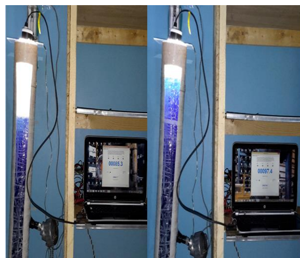
Figura 15 Conexión de un sensor ultrasonico de nivel. Fuente: acervo personal
